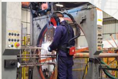
La fabrication d'armature
