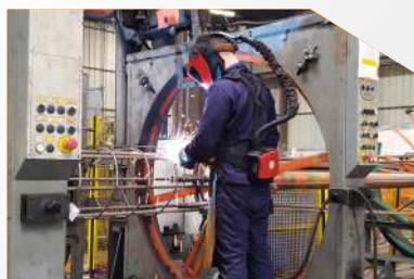
La fabrication d'armature
